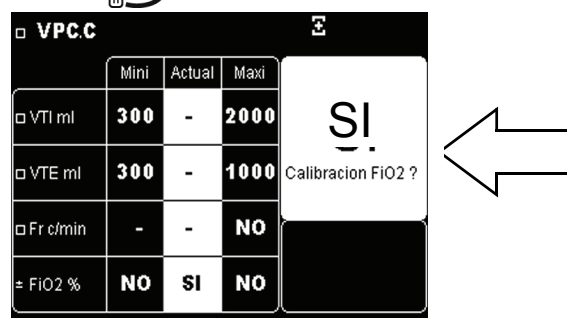
Figura 10-7. Calibración del sensor de FiO 2 (3)
